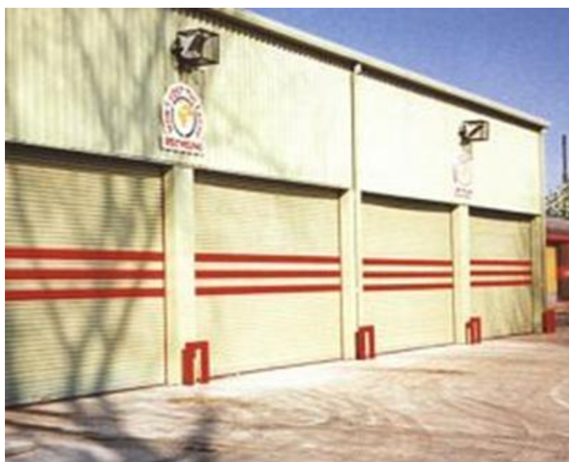
Hình D.3 - Ví dụ về cửa toàn mảng dạng cuốn (Sectional Rolling Shutter)
